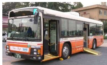
ノンステップバス (床面を超低床構造にした乗降しやすいバス)
