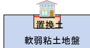
タイプ③ 軟弱地盤を砂で置き換えた宅地
