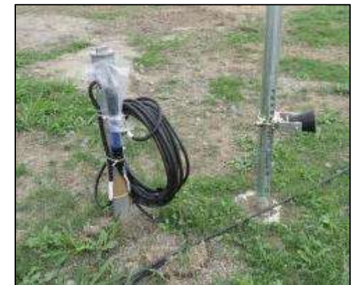
観測機器(水位・沈下)
