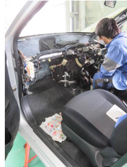
【エアコン整備】
