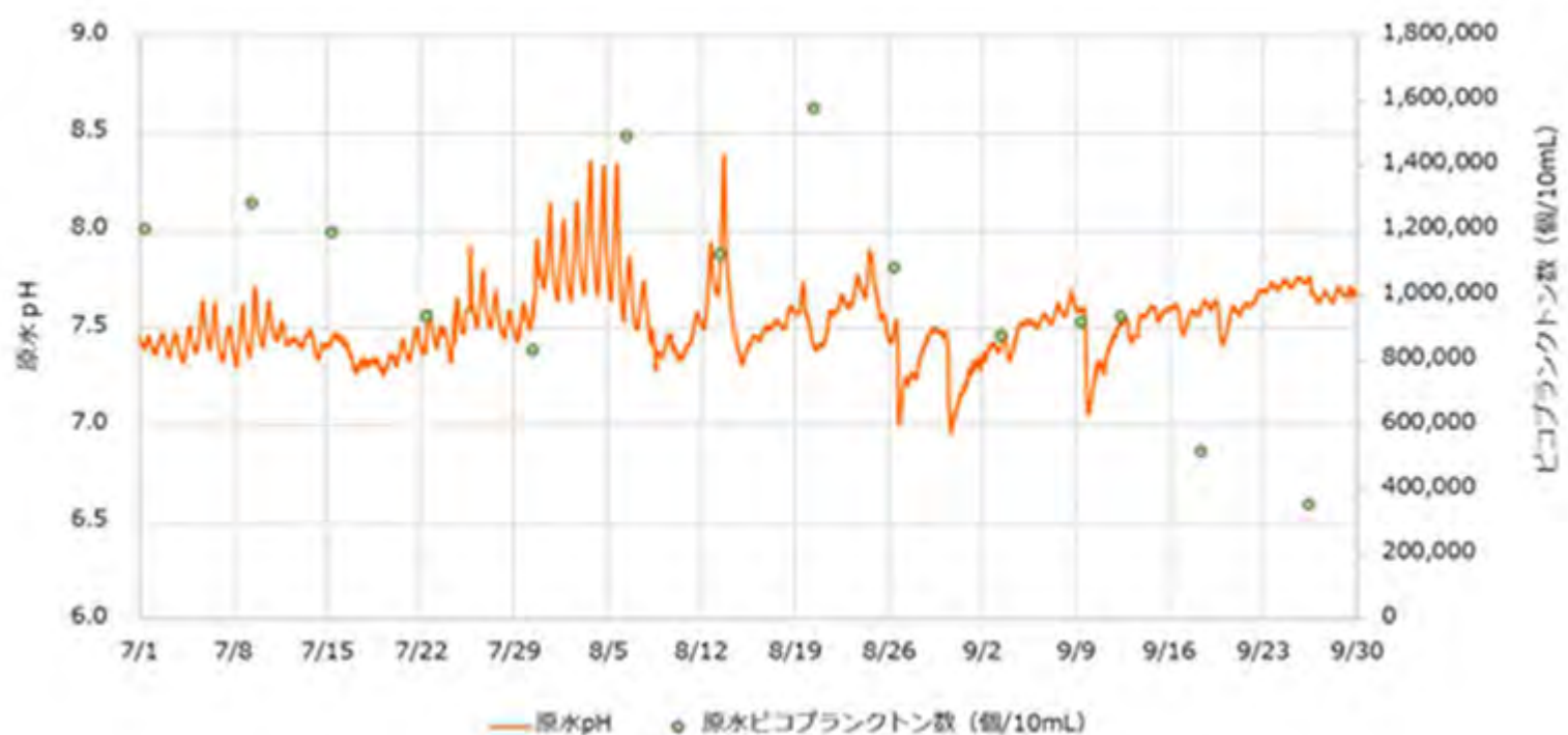
図3-2-3 夏期における原水pHと原水ピコプランクトン数の推移
