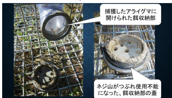
図1 破損したエサ収納部
