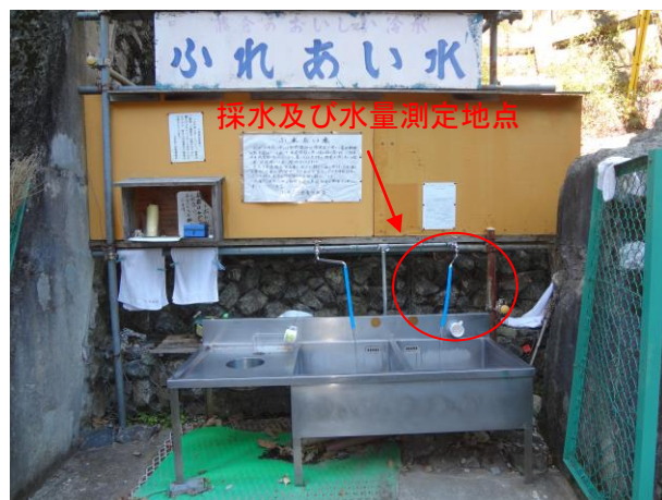
水汲み場が整備されている 蛇口から採水及び水量の測定を行った
