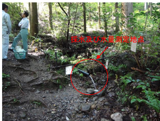
管の出口から採水及び水量の測定を行った
