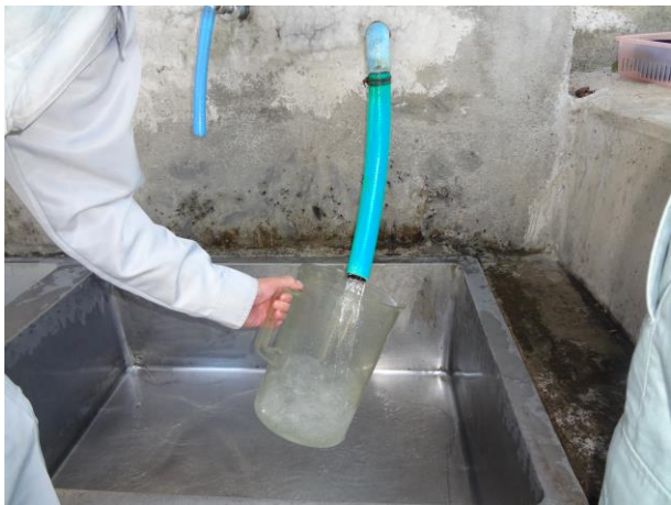
全ての蛇口を閉め、オーバーフロー専用の出口で採水及び水量の測定を行った
