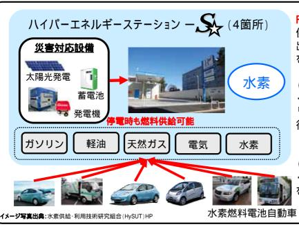
FCVにも対応した、多様なエネルギーを 供給でき、災害時も燃料を供給することが 出来る「ハイパーエネルギーステーション S」 を4箇所整備。
