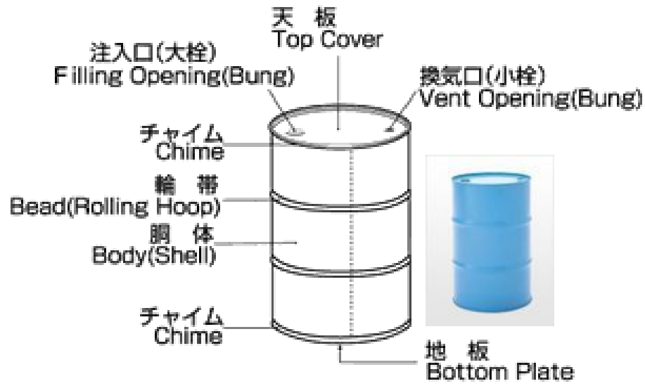
タイトヘッドドラム缶 (クローズドラム缶、密栓ドラム缶)
