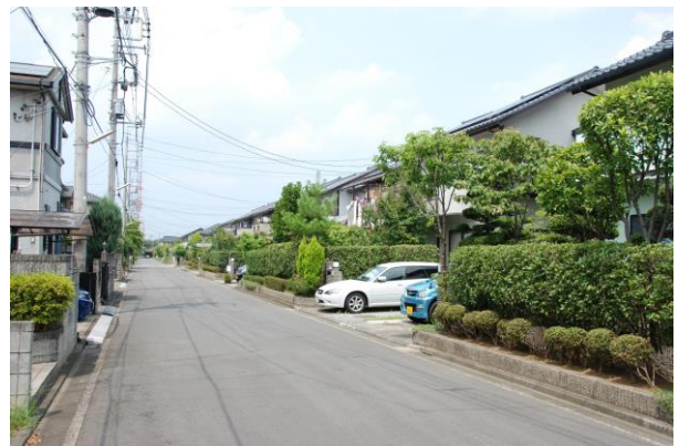
建物の高さを揃え、道路境界線から後退しているため、圧迫感を軽減
