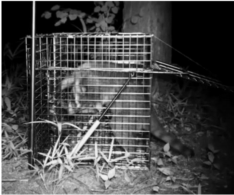
アライグマの捕食行動を利用した 専用捕獲器「ラクーンキューブ」の開発
