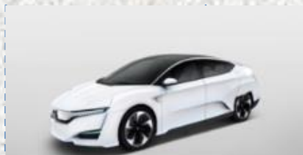
水素で走る電気自動車 (水素+酸素⇒電気・水)
