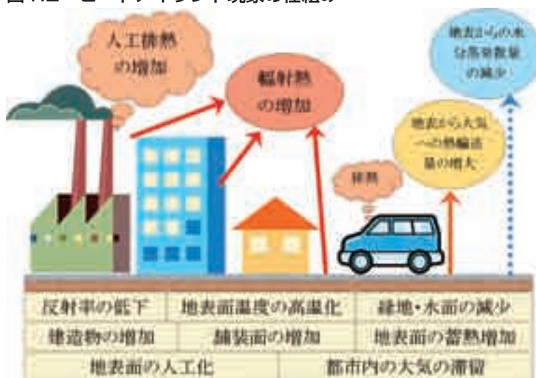
図1.2 ヒートアイランド現象の仕組み
