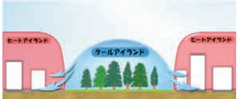
図1.20 クールアイランドの形成と冷気にじみ出し模式図
