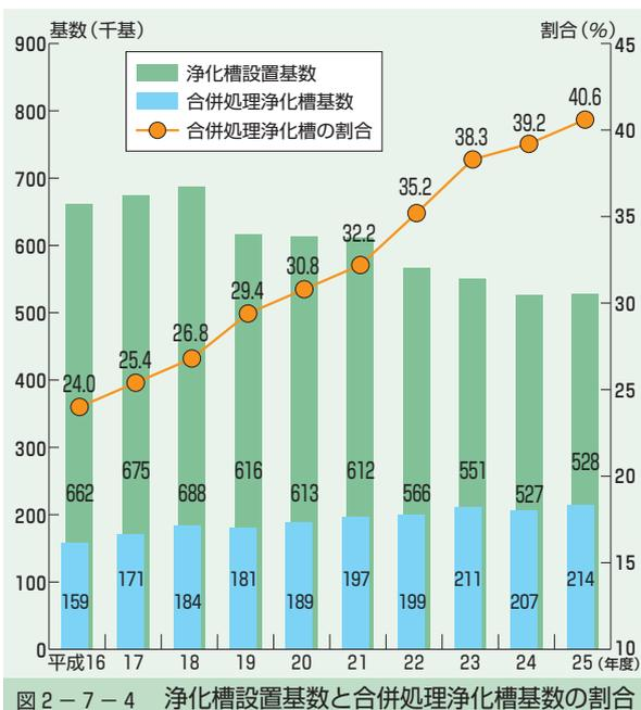
図2-7-4 浄化槽設置基数と合併処理浄化槽基数の割合
