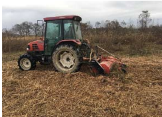
フレールモアによる雑草刈払作業
