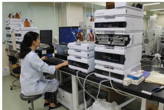
検査機器を用いた食品添加物検査
