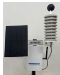
図1 共同開発したIoT暑さ指数計
