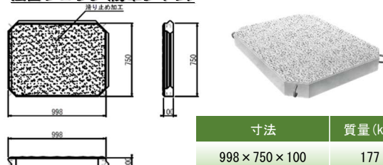
法面ブロック(防草タイプ)
