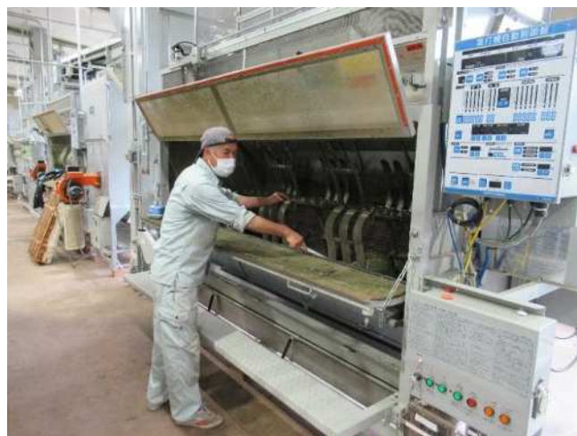
製茶機械の点検、整備
