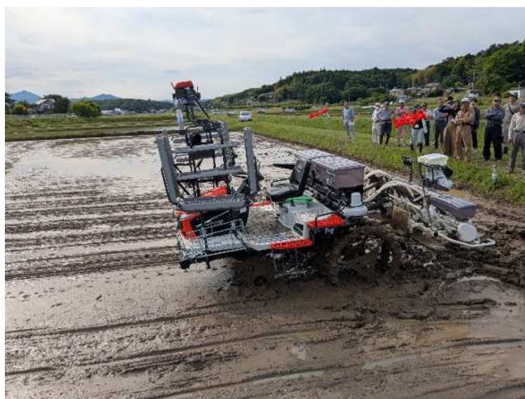
GPSを搭載した無人田植機（湛水直まき）の実証実験 （鳩山町）
