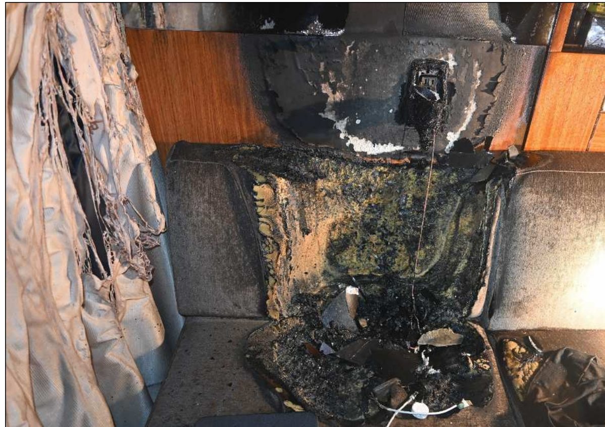
モバイルバッテリーのリチウムイオン電池から出火し、消火後の状況
