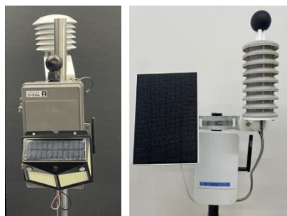
図 2 IoT 暑さ指数計（左：環境科学国際センター開発の機器、 右：株式会社渡辺製作所製の機器）
