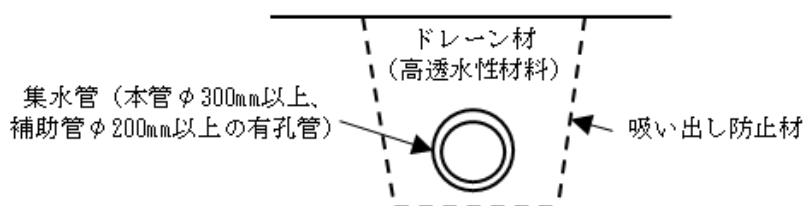
図1-7-51 暗渠排水工の基本構造
