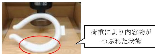
図10 荷重試験により変形した製品
