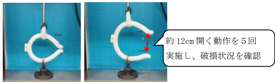
図7 引張試験の状況
