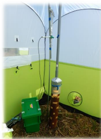
観測井戸のガス流量調査
