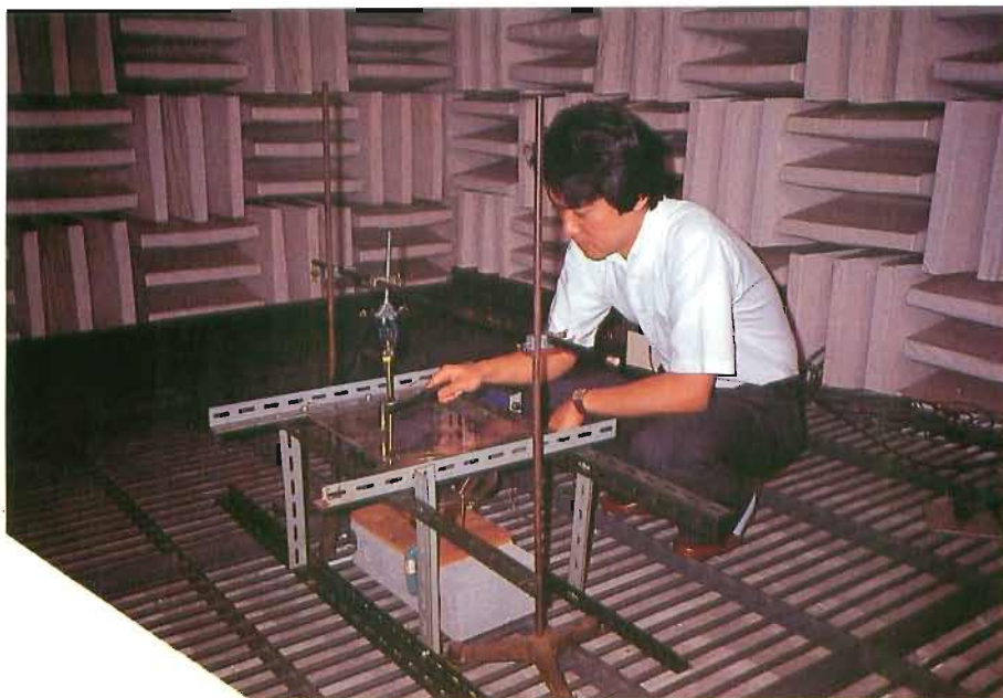
▲ 低周波音の発生機構を明らかにするための無響室内模型実験。これにより、特に振動放射による低周波音の診断技術と発生源対策手法の確立が図られた。
