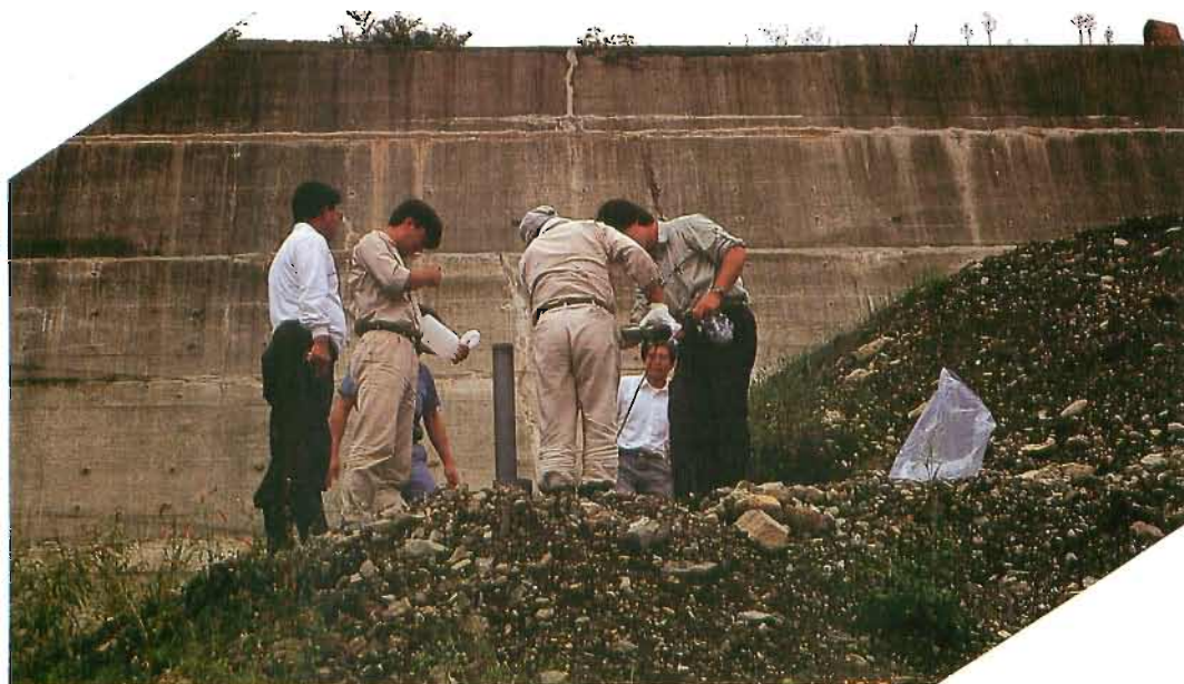
▲ 産業廃棄物最終処分場観測井でのサンプリング。処分場からの浸出水を検査する。
