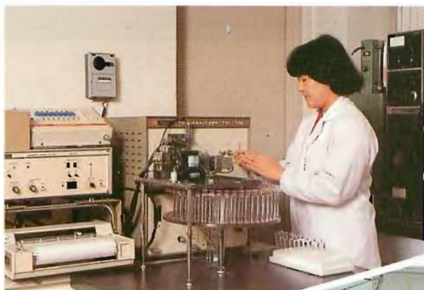
◀ オートサンプラー付きTOC(全有機炭素)計を使っての測定。TOCは水質汚濁の一つの指標となっている。
