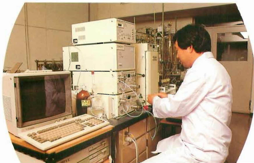
▲ 高速液体クロマトグラフを使って、排出水の組成を分析。三次元クロマトグラフにより排出水の全体像が把握できる。
