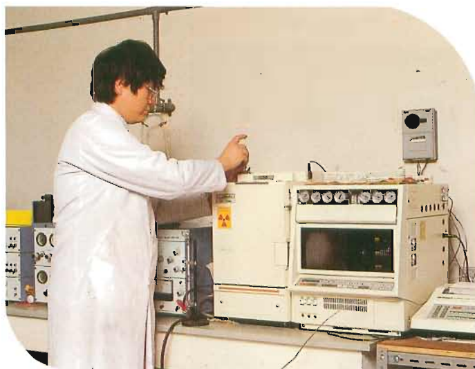
▲ 浸出水に有害化学物質が含まれていないか、ガスクロマトグラフで分析。
