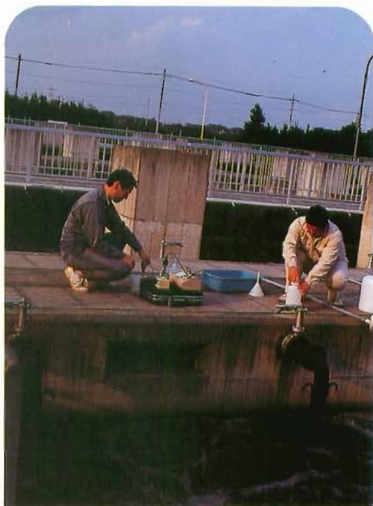
▲ 工場等での各工程の排水を採取。汚濁物質の処理方法等について検討し、排水処理技術の特性を把握する。
