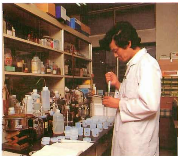
▲ し尿処理場から採取した検体中の窒素、リン等を分析。分析のための前処理にも時間がかかる。
