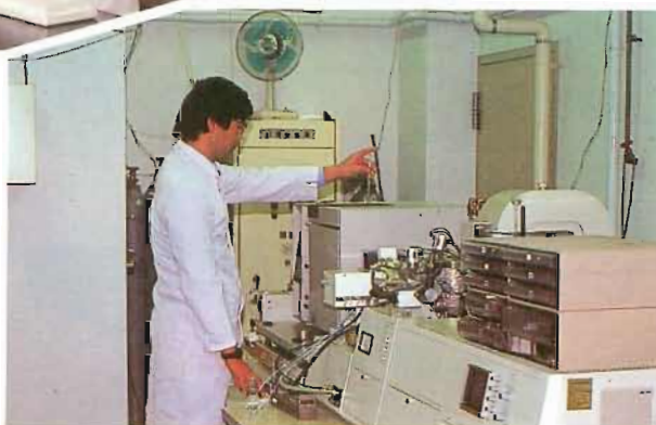
▲ 最新型のLC・GC-MS分析装置。一度に多種類の微量化学物質を迅速に分析することができる。
