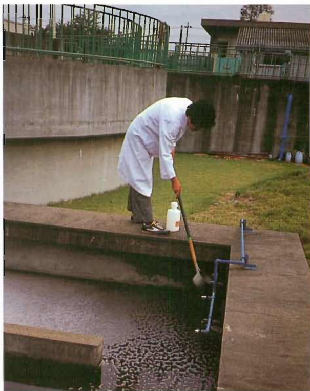
▲ し尿処理場の処理水を採取。採取した検体を持ち帰り、その水質の良否を検査する。
