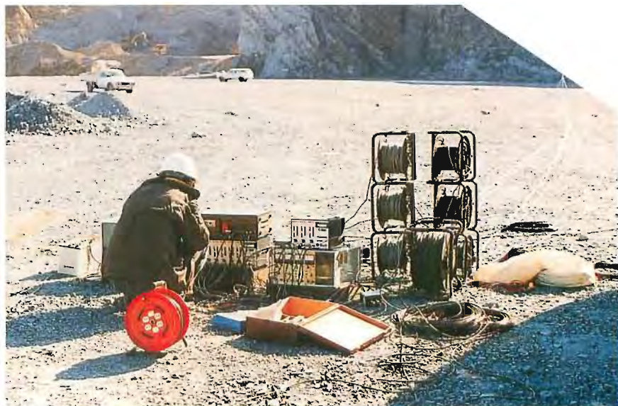
▲ 岩石採取場での発破に伴う低周波音、地盤振動の調査。 この調査結果は、岩石採取認可に当たっての資料に供されている。
