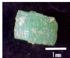
写真1 劣化した泥落としマットの細片
