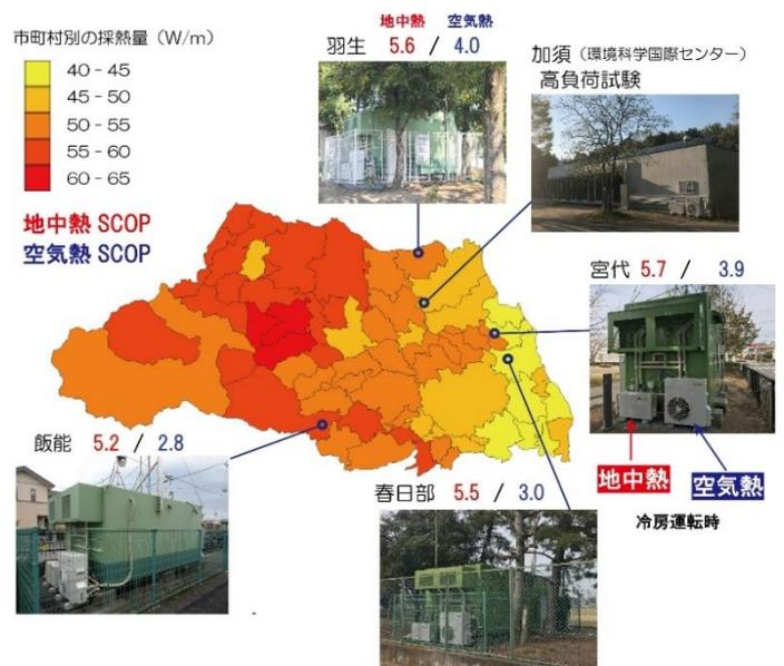
図2 地中熱ポテンシャルマップと実証試験結果
