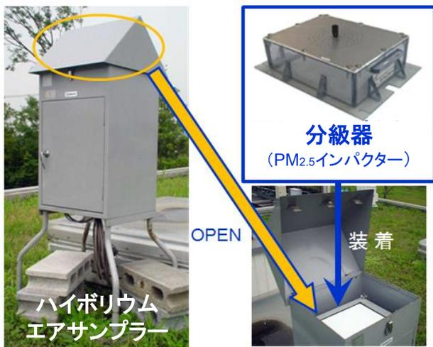
図1 ハイボリウムエアサンプラーと分級器
