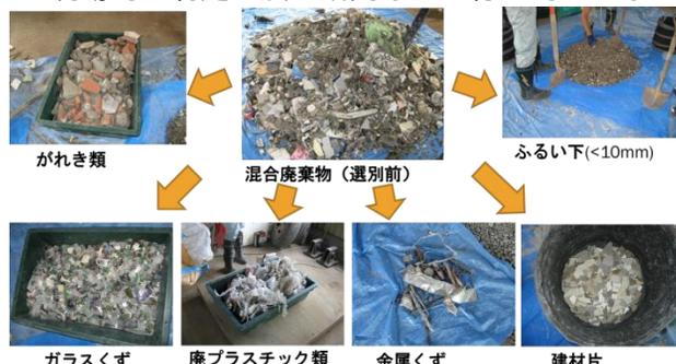
図2 建設混合廃棄物の選別実験例
