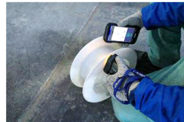
プラスチックセンサーによる選別 (慣れてくるとセンサー無しで選別可)
