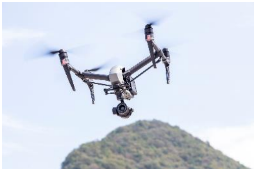
ドローンを活用した法面の測量
