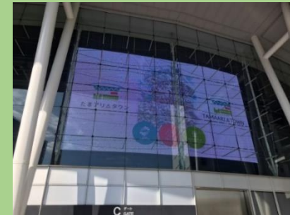
■Cゲートに設置した700インチ透過型LEDビジョン 約40万個のLED素子を使用し、幅16m、高さ9mのスクリーンに映像表示
