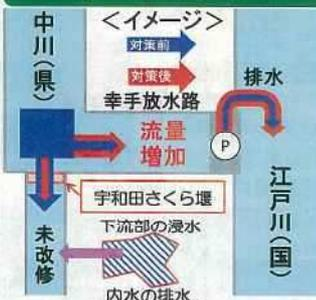
中川流域の浸水被害を早期に軽減させる対策として、中川の洪水を効率的に江戸川へ排水するための堰(宇和田さくら堰)が一級河川中川と幸手放水路との分流部に整備され、令和3年6月から供用を開始しています。
