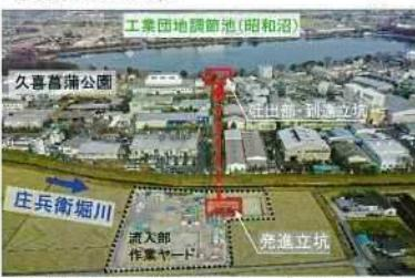
延長約300mの導排水路のイメージ図(委託・工事)
