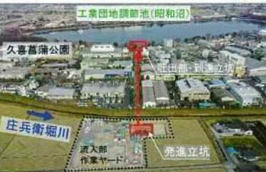
延長約300mの導排水路のイメージ図(委託・工事)
