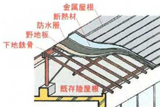
図9 置き屋根の断面図
