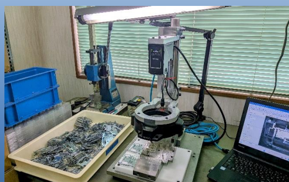
自社の固定具と合わせた AI × 光学ズーム搭載ビジョンシステム
