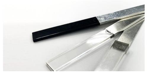
近年ねじや接着剤のような締結要素を使わずに、異なる2つの材料を強固にくっつける異種材接合が注目を浴びています。金属異種材料接合技術と金属接合性 PC の組み合わせによって強固な接合特性を持つ「金属+樹脂接合部材」を具現化し、部品点数・組立工数削減に寄与します。
