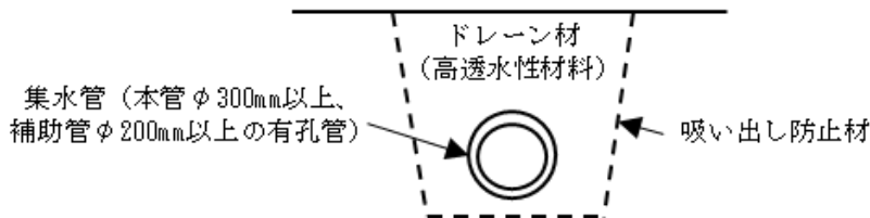
図1-7-49 暗渠排水工の基本構造
