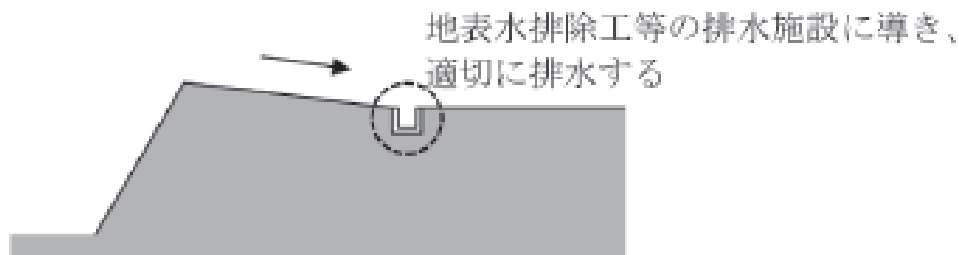
図 1-7-9 崖面天端の排水例
