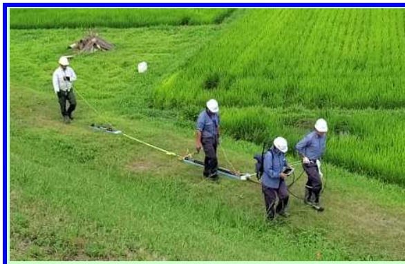
改良版牽引式電気探査機器による調査風景
