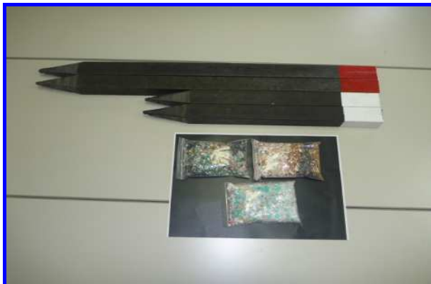
下段: 廃プラ原料(袋)、上段: 成型測量杭(製品)
