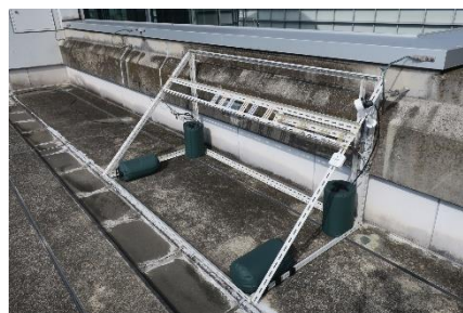
図1 耐候性試験の状況
