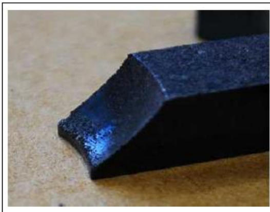
写真2 圧粉磁心ならではの三次元形状製品
