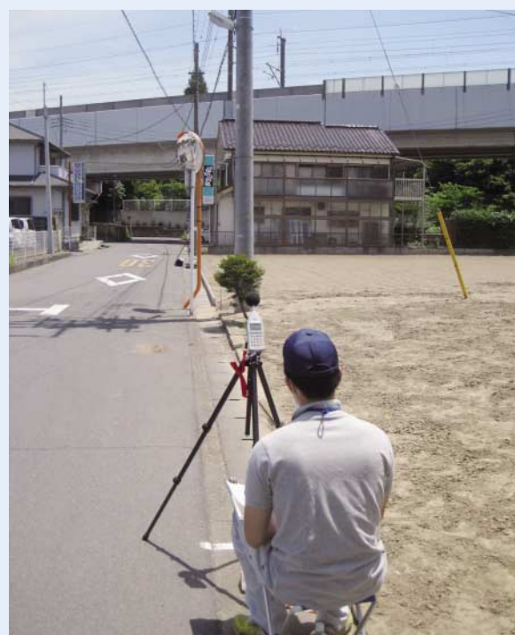
写真 1-4-1 新幹線鉄道騒音測定風景
