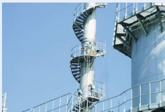
写真 1-3-4 排出ガス中のダイオキシン類濃度の測定
