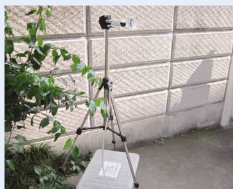
写真 1-3-3 石綿除去作業周辺の石綿濃度測定
