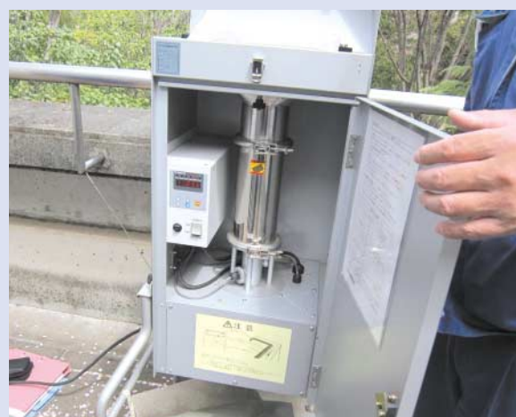
大気中の有害物質を分析用に捕集するための装置
