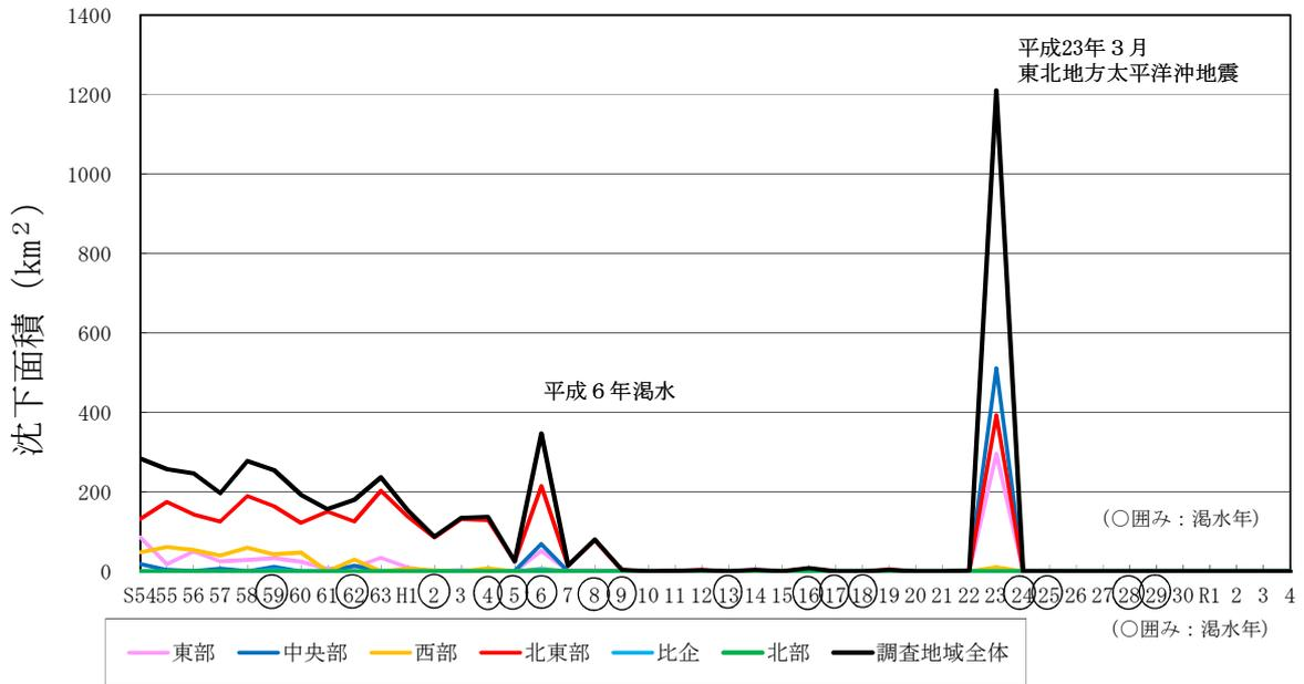
図1-11 地盤沈下地域の経年変化図
