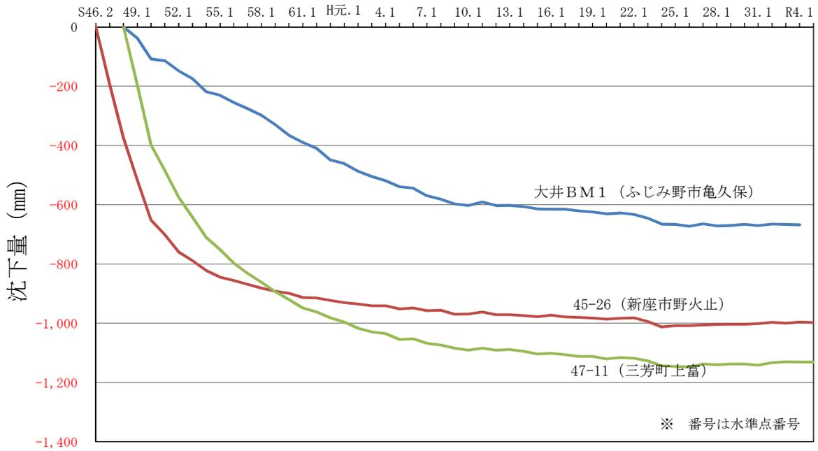
図1-9 地盤沈下経年変化図（幸手市、久喜市）
