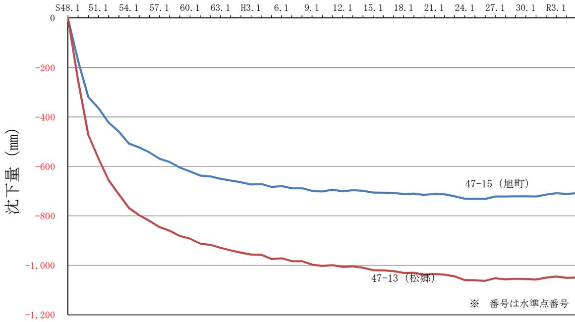
図 1 - 8 地盤沈下経年変化図 (ふじみ野市、新座市、三芳町)
