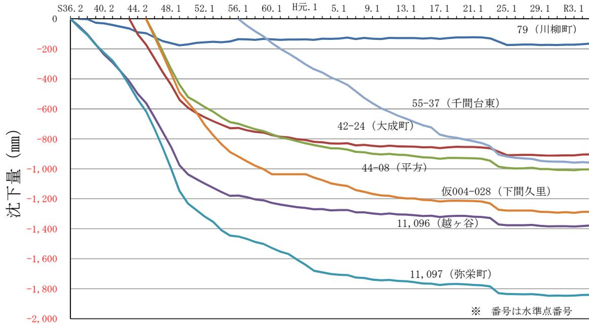
図 1 - 4 地盤沈下経年変化図 (春日部市)
