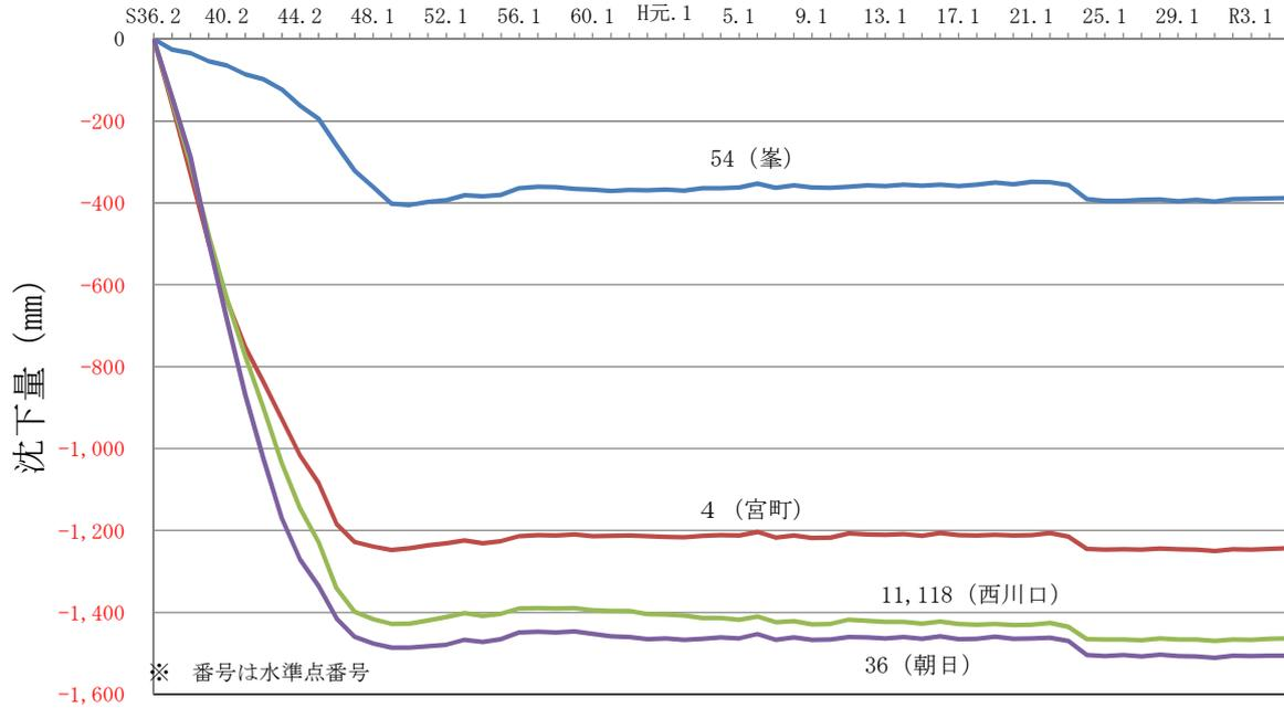
図 1 - 6 地盤沈下経年変化図 (さいたま市)
