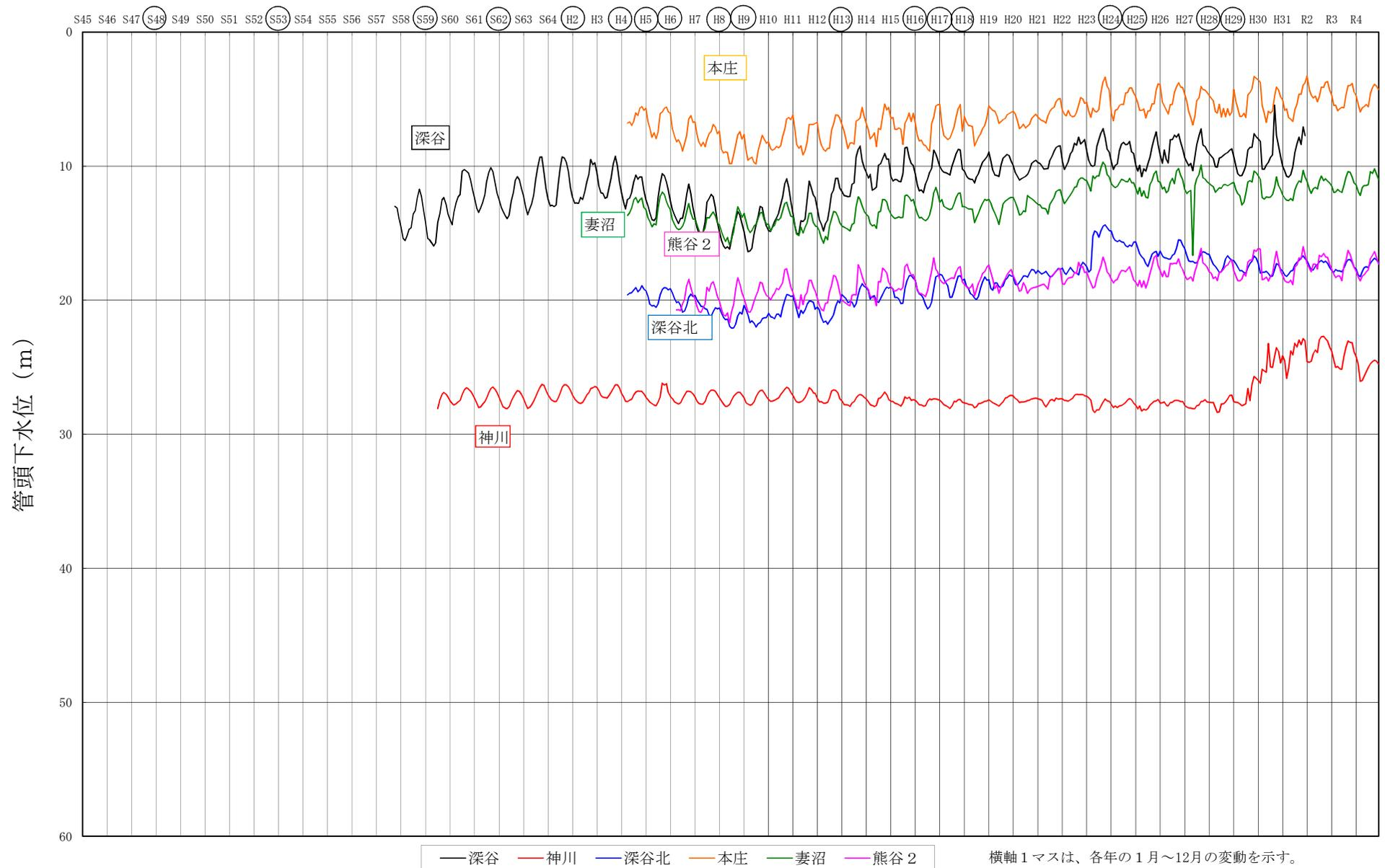
図1-18 地下水採取量・地下水位・地盤沈下の相関図（さいたま市）（浦和観測所）
