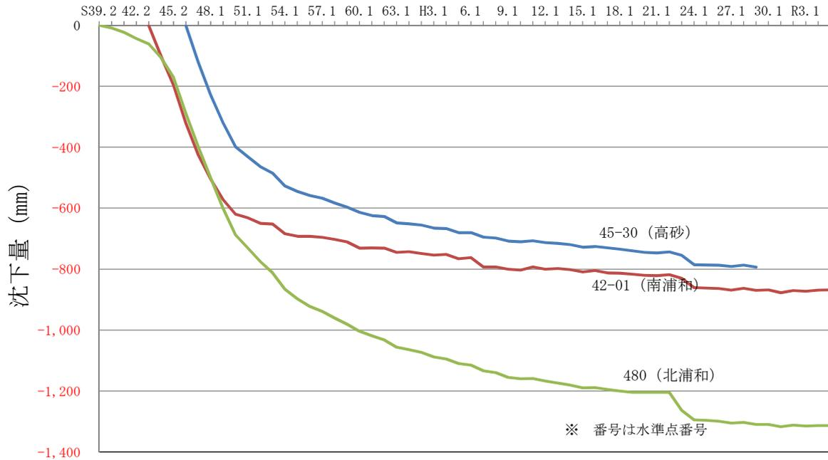
図 1 - 7 地盤沈下経年変化図 (所沢市)
