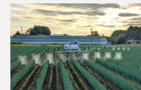
自立走行型ロボットによるねぎの農薬散布
