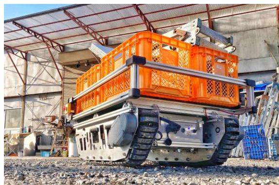
資機材運搬、センサーを装着して自動走行など
