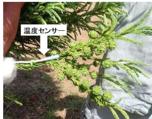
図2 供試枝と温度センサーの外観
