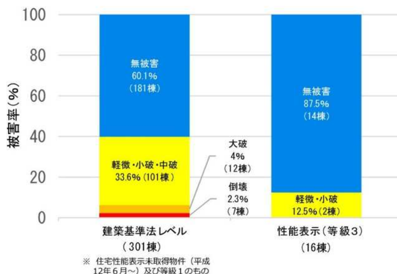
＜住宅性能表示制度創設（平成12年10月）以降の木造建築物の被害状況＞ （建築基準法レベル※と住宅性能表示取得物件（等級3）の比較）
