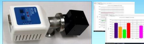
新開発の独自方式によって低真空でも残留ガス成分の測定ができます(10<sup>-6</sup>Pa~50Pa)。全圧真空計としても大気圧から超高真空まで測定可能。全自動なので排気開始や大気導入の時にもON/OFF操作は不要で誰でも簡単に使えます。真空装置に繋いでおけば突然のリークやガス放出などの異常を素早くキャッチし不良の低減に役立ちます。ヘリウムやアルゴンを吹き付けてリーク探しなどのメンテナンスにも利用できます。フィラメントを持たず、汚れに強く、汚れてもユーザーメンテナンスが容易に可能。
